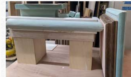
Utilisation de l'ArmaPET Eco50 pour fabriquer un banc et un chapiteau pour le film Olympe, une femme dans la Révolution de Julie Gayet et Mathieu Busson, production : Moteur s'il vous plaît, 2024. © Valérie Valéro
